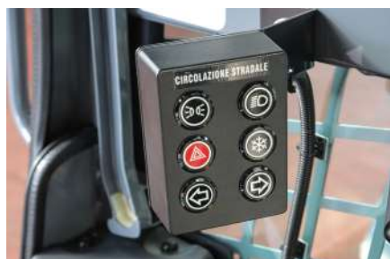
PULSANTIERA CIRCOLAZIONE STRADALE
