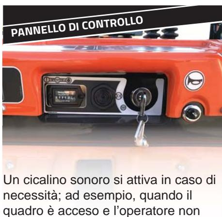
Un cicalino sonoro si attiva in caso di necessità; ad esempio, quando il quadro è acceso e l'operatore non avvia il motore. Il contatore inoltre permette di contare la vita della macchina.
