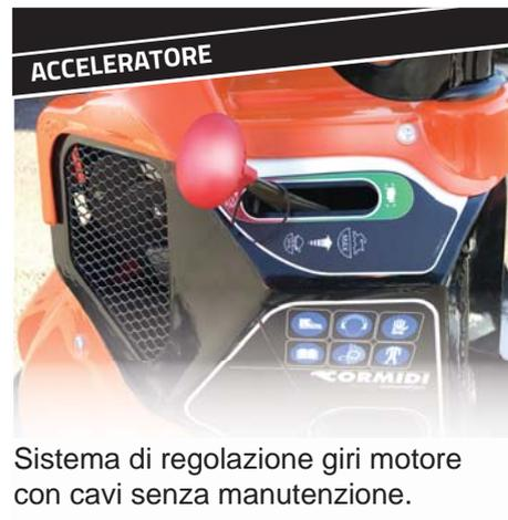
Sistema di regolazione giri motore con cavi senza manutenzione.
