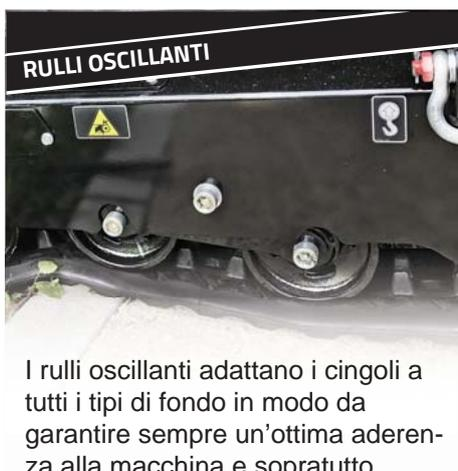
I rulli oscillanti adattano i cingoli a tutti i tipi di fondo in modo da garantire sempre un'ottima aderenza alla macchina e soprattutto grande stabilità su sterrati particolarmente ardui.
