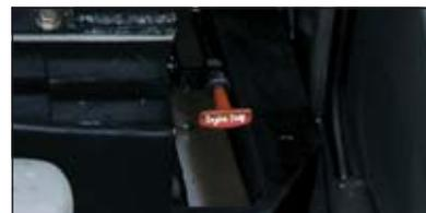
Leva di esclusione circuito di pilotaggio
